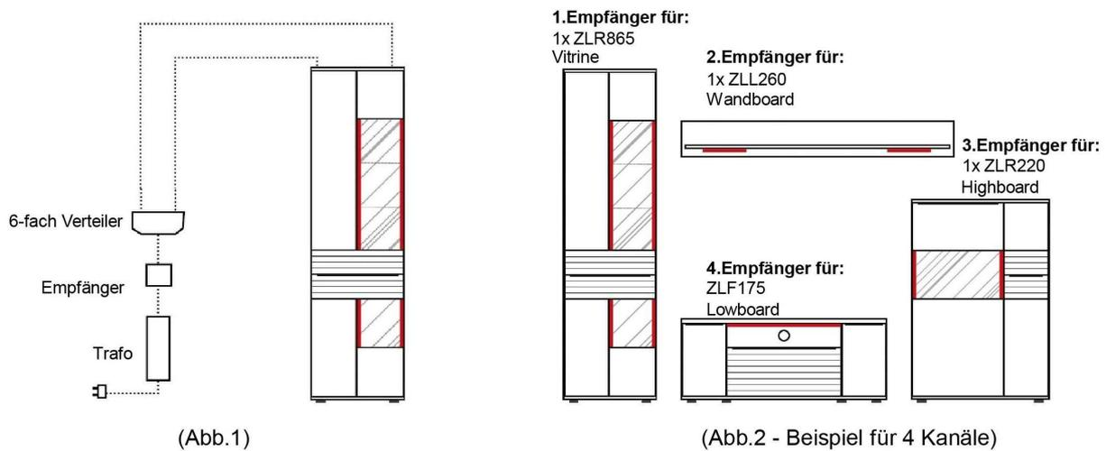
Die Montage des Empfängers erfolgt bei jedem Set immer zwischen Trafo und 6-fach Verteiler. (Abb.1)
